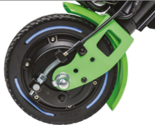
Sistema de frenos dual (tambor y frenos electrónicos)
