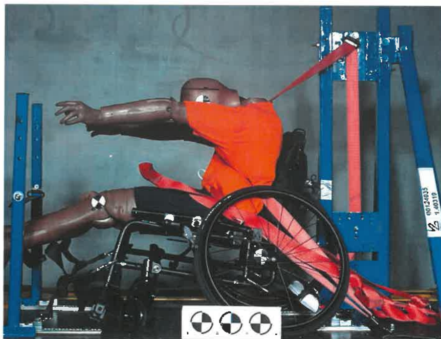
Fot. 3. Maksymalne przemieszczenia poziome do przodu Pic. 3. Maximum horizontal excursions to the front
