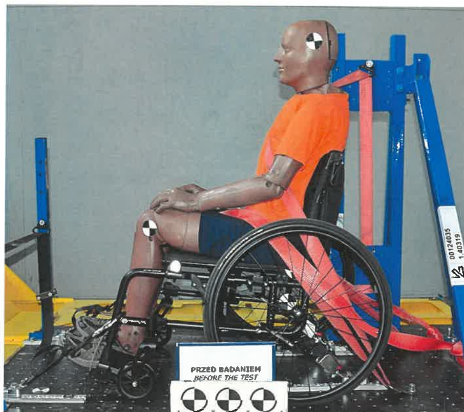
Fot. 2. Wózek inwalidzki Icon 30FAF przed testem dynamicznym Pic. 2. Wheelchair Icon 30FAF before dynamic test
