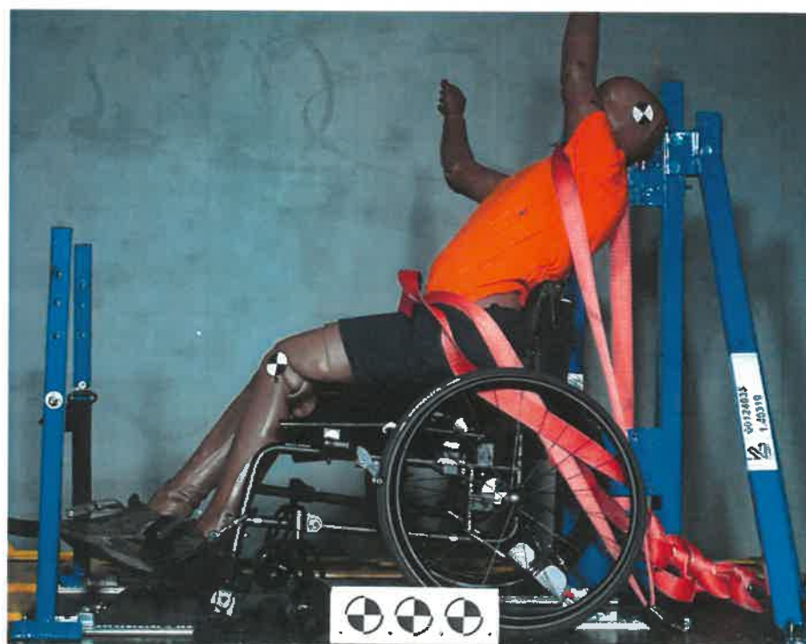
Fot. 4. Maksymalne przemieszczenia poziome do tyłu Pic. 4. Maximum horizontal excursions backward
