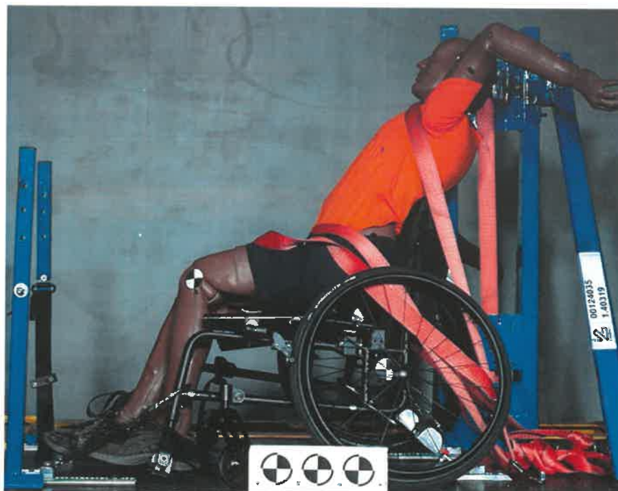
Fot. 5. Wózek inwalidzki Icon 30FAF po teście dynamicznym Pic. 5. Wheelchair Icon 30FAF after dynamic test
