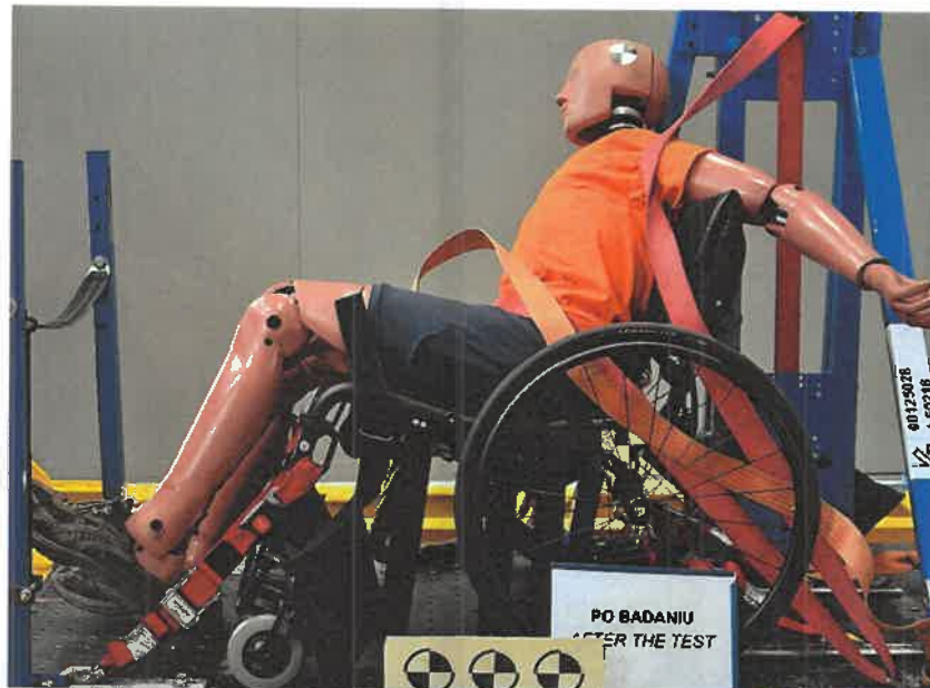
Fot. 5. Wózek inwalidzki Icon 60 po teście dynamicznym Pic. 5. Wheelchair Icon 60 after dynamic test
